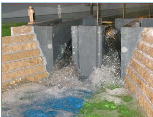
beidseitiger Überfall der HWE bei PMF (Blick von Unterstrom)
